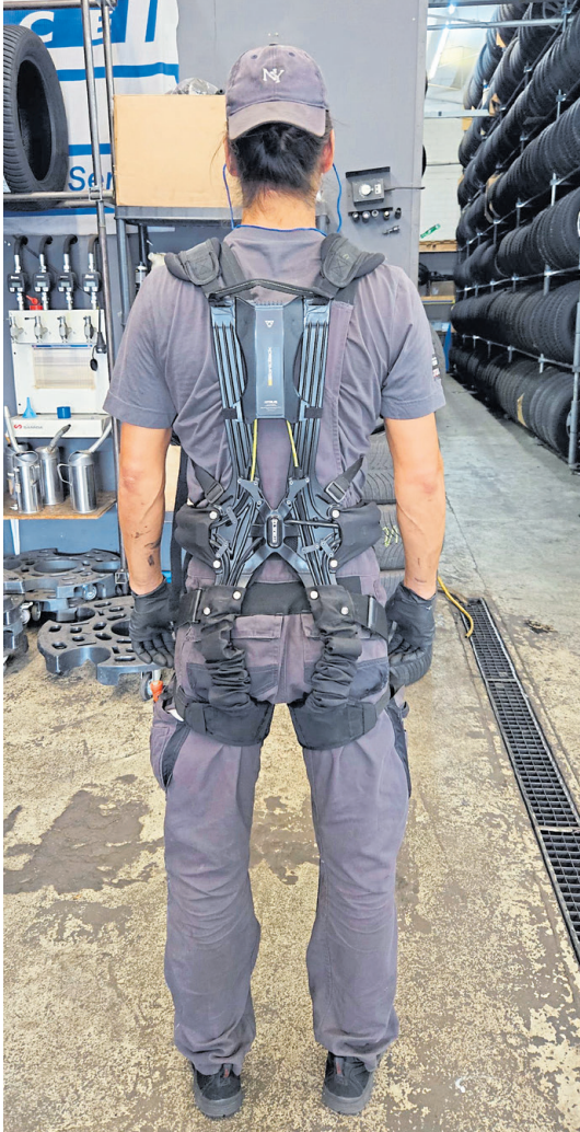
Ein Reifen plus Felge kann bis zu 50 Kilogramm wiegen. Nurgali Gaisin, Monteur bei Steiner Reifen und Kfz-Technik in Konstanz, nutzt zur Unterstützung ein Exoskelett. Durch die Hebehilfe werden Gelenke weniger belastet und die Muskulatur ermüdet nicht so schnell.
