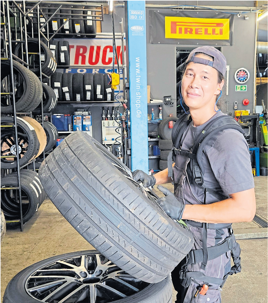
Ein Reifen plus Felge kann bis zu 50 Kilogramm wiegen. Nurgali Gaisin, Monteur bei Steiner Reifen und Kfz-Technik in Konstanz, nutzt zur Unterstützung ein Exoskelett. Durch die Hebehilfe werden Gelenke weniger belastet und die Muskulatur ermüdet nicht so schnell.
